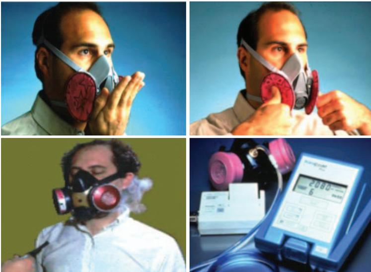
호흡보호구의 기밀 테스트(상)와 Fit 테스트(하). 기밀 테스트는 숨을 내쉴 때 하는 양압검사(좌상)와 숨을 들이마실 때 하는 음압검사(우상)가 있고, Fit 테스트는 정성검사(좌하)와 정량검사(우하)가 있음 (www.osha.gov).
