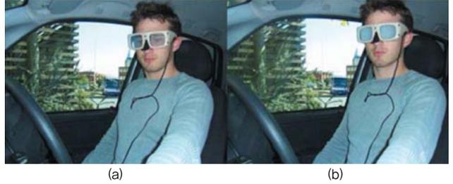
[그림 1] 차폐 고글의 작동 모습(Pettitt, 2008). (a)는 셔터 개방상태이며, (b)는 셔터 차폐상태이다.
