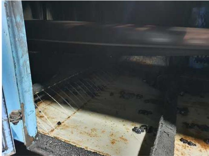
[그림 A4-7] 공기부양식 컨베이어 테일 부위 하부에 설치된 연속 물청소 장치
