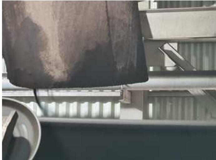
[그림 A3-9] 슈트부위의 국소배기장치에서 포집된 분진이 다음 컨베이어의 테일 부위 위로 배출되며 분진이 비산되는 모습(그림 A3-8의 확대사진)
