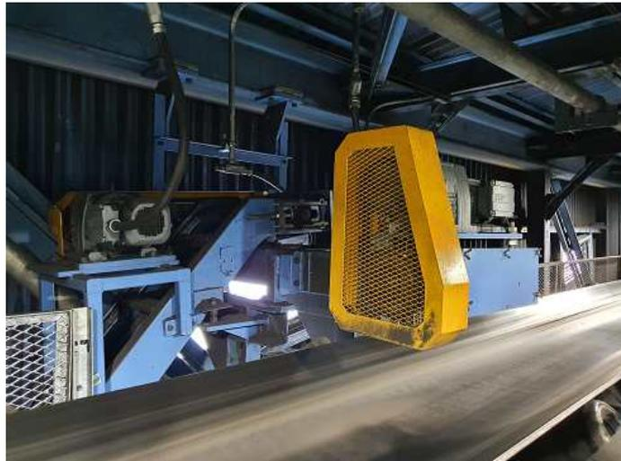
[그림 A4-6] 컨베이어라인 헤드부위 하부에 설치된 자동낙탄회수장치
