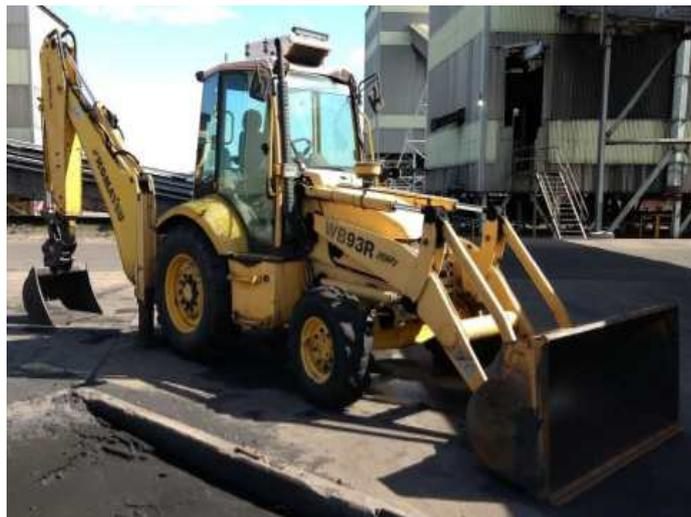
**[그림 IV-10] 중기 케빈 상부에 설치된 헤파필터 공기 공급장치. 사진출처 : The State of Queensland, 2018**
