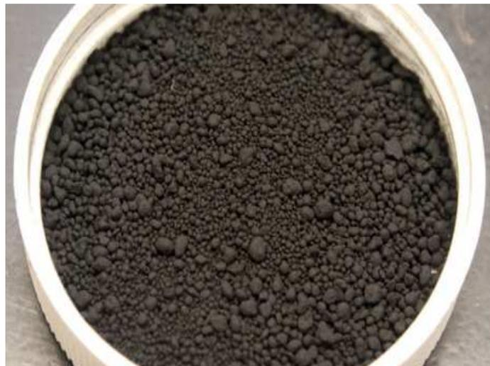
**[그림 IV-8] 펠릿 제조장치로 펠릿화된 분탄.** 사진출처 : <https://feeco.com/pin-mixers/>
