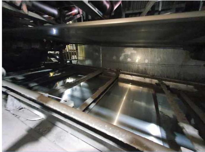
[그림 A4-5] 컨베이어라인 헤드부위 하부에 설치된 자동낙탄회수장치
