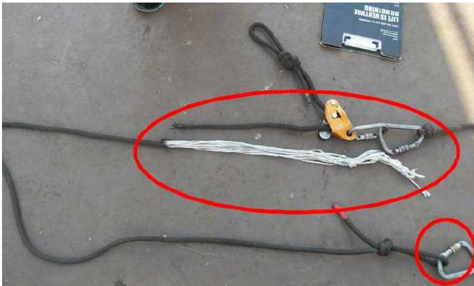
[그림 Ⅲ-8] 랜아드가 파단된 양쪽 끝 모습 및 체결 고리
