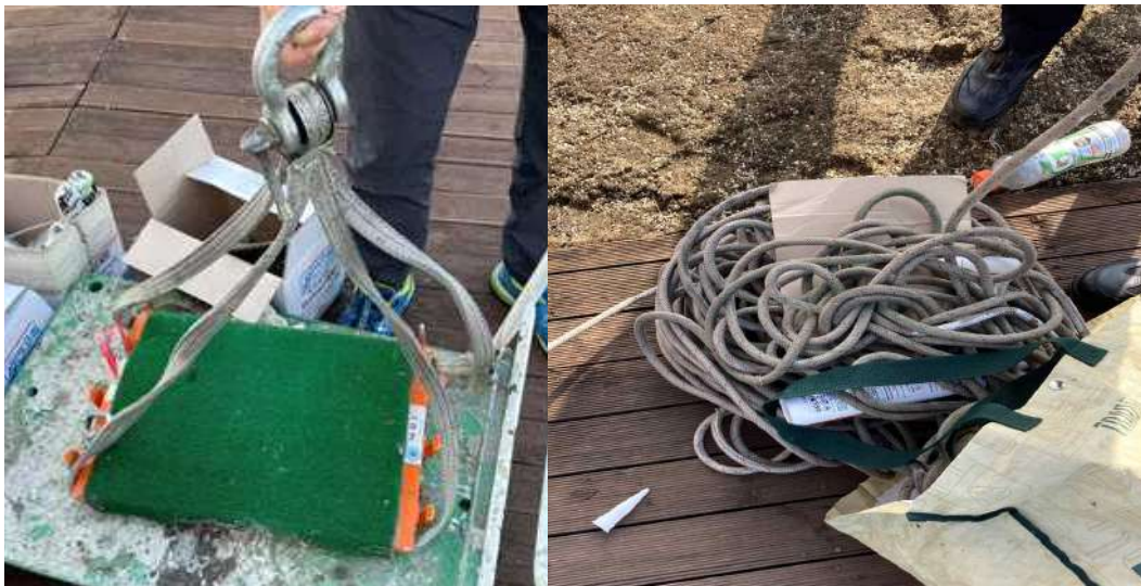
[그림 III-12] 재해자가 탑승한 달비계(좌) 및 로프(우)
