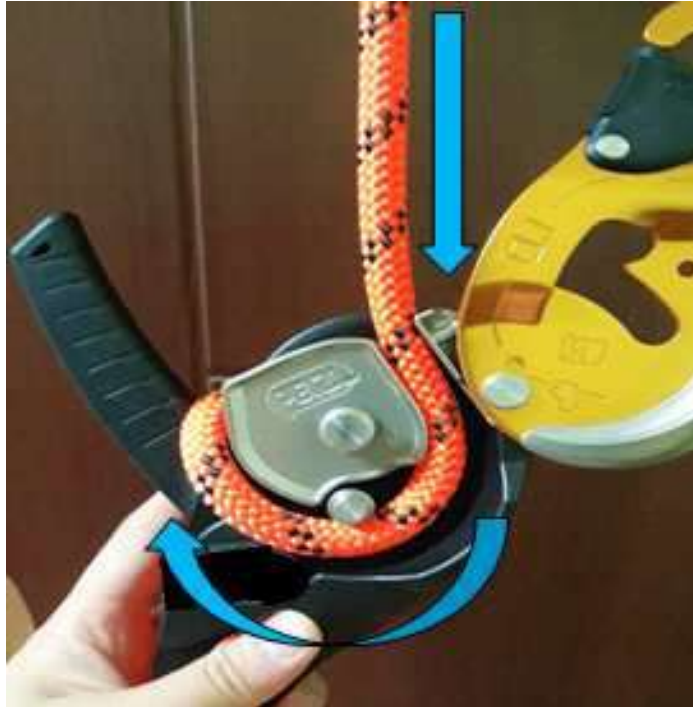
[그림 Ⅲ-13] 잘못된 하강기 장착 방법
