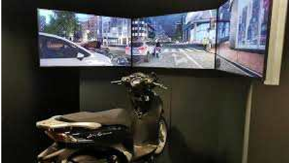
[그림 III-97] Lander 회사의 이륜차 시뮬레이터 예시
