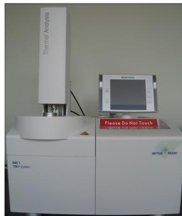
[그림 9] 시차주사열량분석(DSC) 장치
