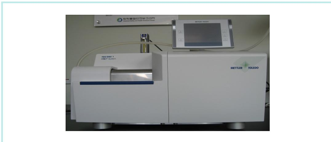
[그림 11] 열중량분석(TGA) 장치
