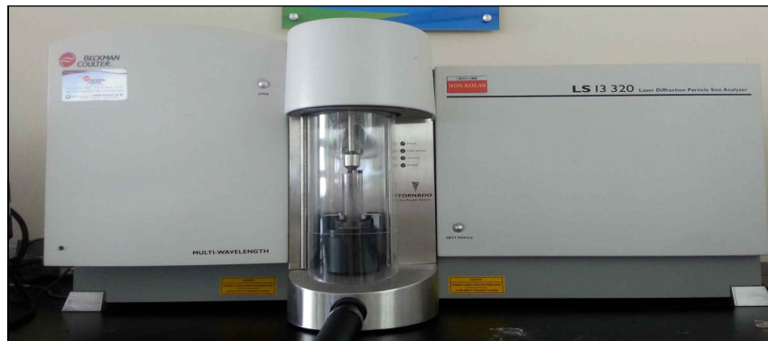
[그림 IV-1] 레이저 회절 입도분석 장비 사진
