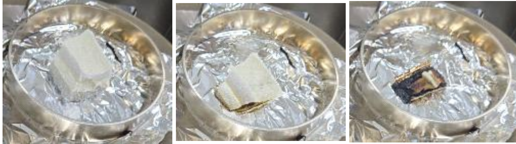
(a) 상온(시험 시작시) (b) 330 °C(30분 경과) (c) 시험 종료 후
