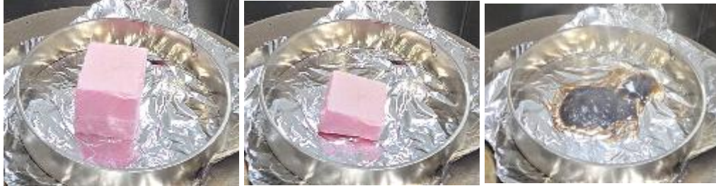
(a) 상온(시험 시작시) (b) 211 °C(18분 경과) (c) 500 °C(46분 경과)
