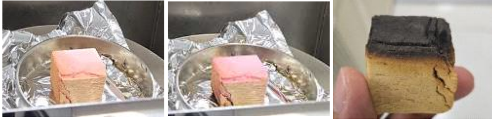
(a) 상온(시험 시작시) (b) 429 °C(36분 경과) (c) 시험 종료 후
