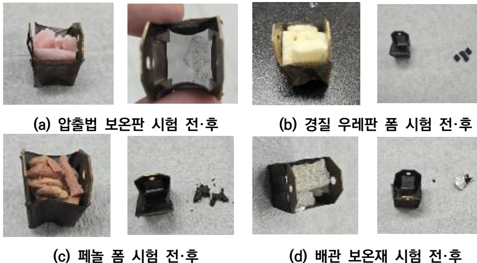
[그림 IV-9] 자연발화점 시험 전·후 시료 모습
