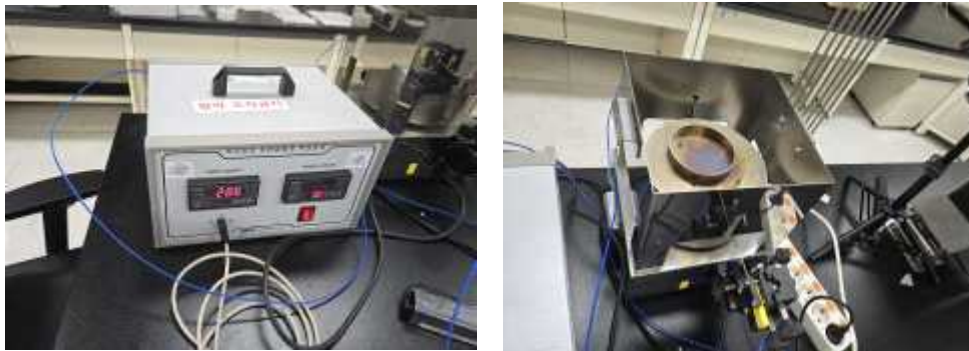
[그림 Ⅲ-1] Hot-Surface Ignition Temperature Tester
