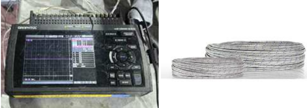
[그림 Ⅲ-6] 데이터 측정장치 및 온도 보상 도선(Thermocouple)
