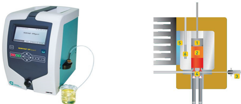
[그림 IV-7] 증기압 측정장비 사진 및 작동 원리
