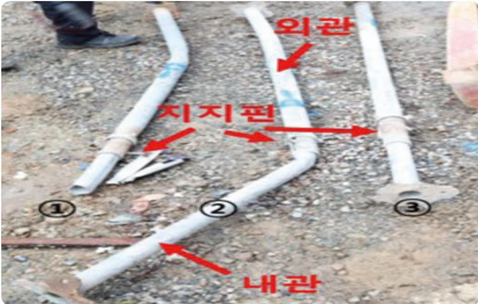
[사진 2] 방2 외부 구조보강 파이프서포트 모습
