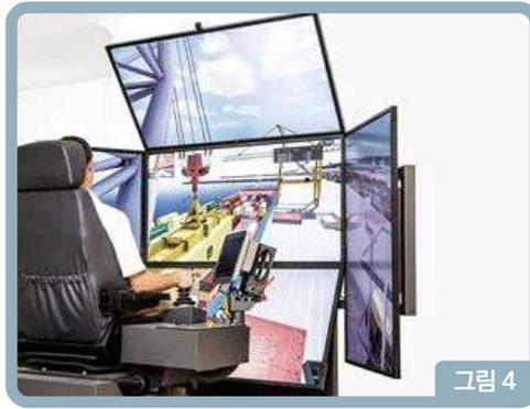
[그림 4] 크레인 원격조종 시스템
