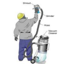
그림 1. 콘크리트 그라인딩에 적합한 이동식 국소배기덮개 (출처: Workplace Solutions, NIOSH 2009)
