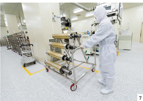
6 LOADER에 설치한 비상정지장치 7 중량물의 샤프트 이동을 편리하게 해주는 이동식 샤프트 보관대
