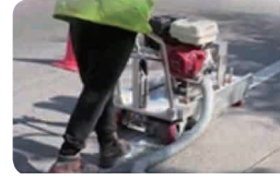
⑥ 차선 제거(유지보수 재도색) 차선 제거기
