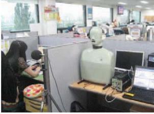
(사진) HATS를 사용한 측정 모습
