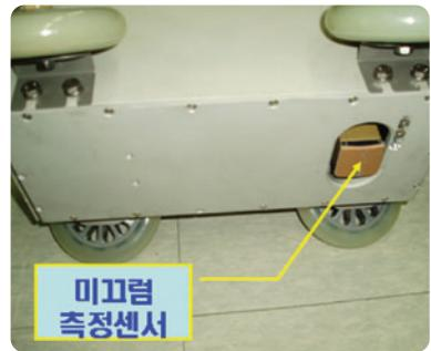
〈그림 9〉 휴대용 미끄러짐 측정 장치
