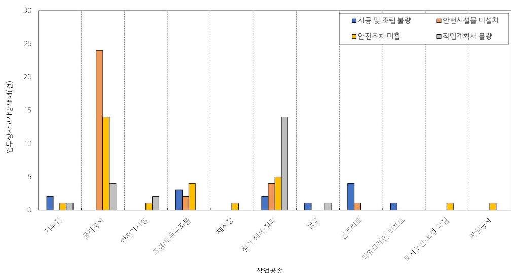
[그림 III-6] 건설공사 중 붕괴사고 발생 작업 공정별 유발 원인
