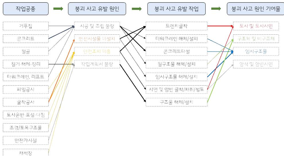
[그림 III-8] 건설공사 작업공종 및 단계별 재해 발생 요인과 경로
