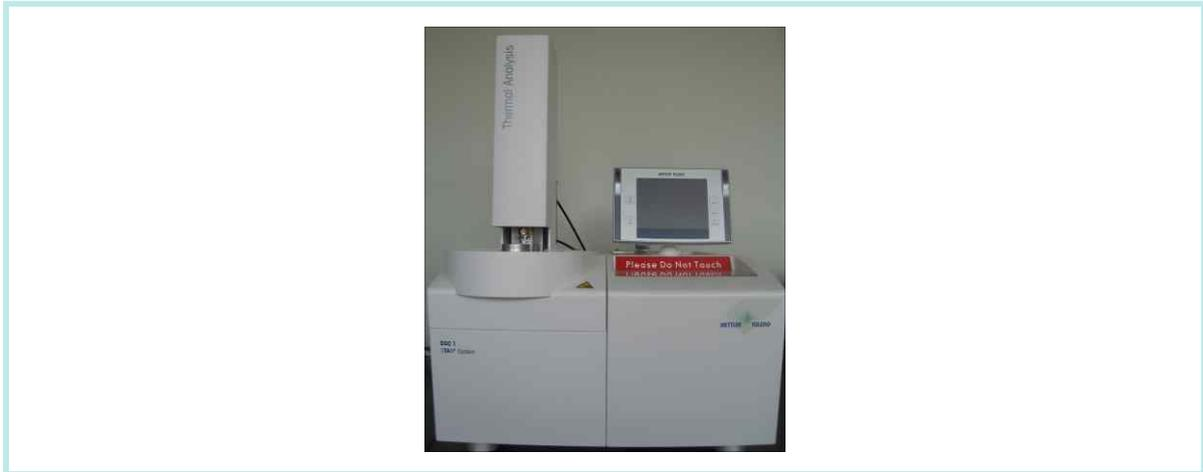
[그림 20] 시차주사열량분석(DSC) 장치
