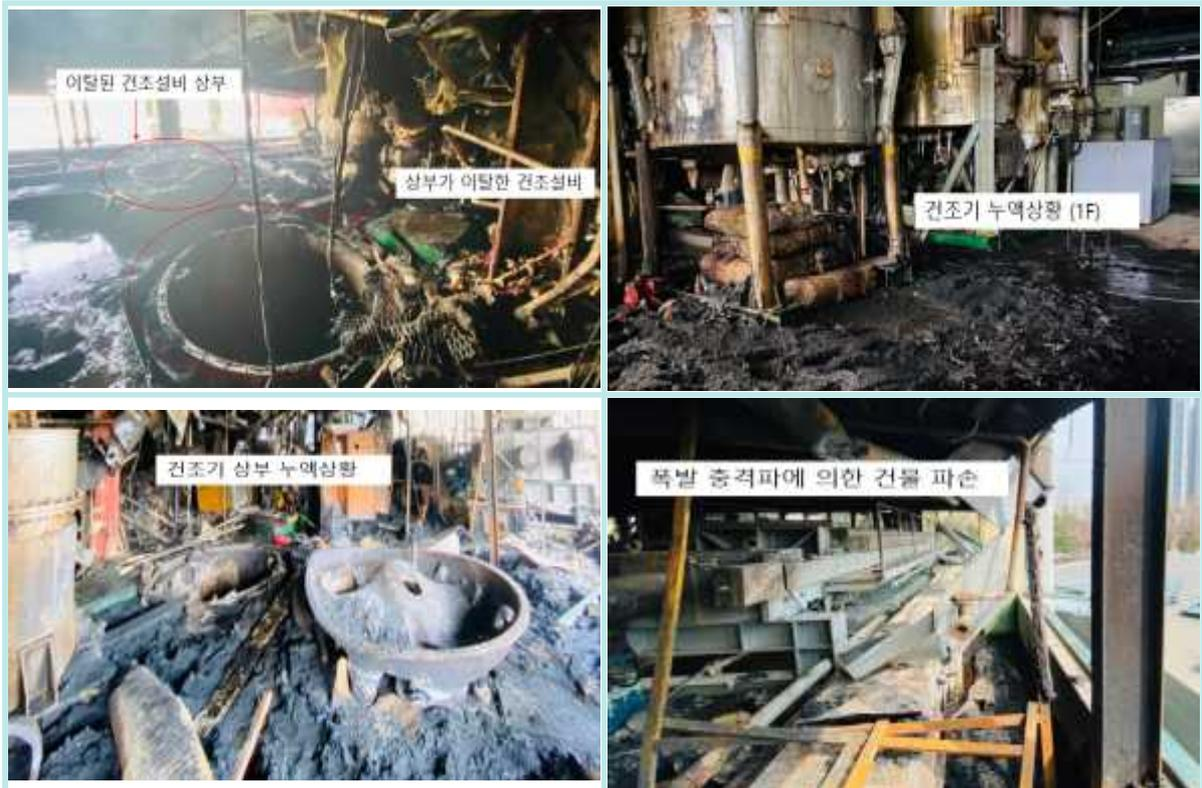
[그림 14] 폭발사고에 의한 설비 및 건물 파손
