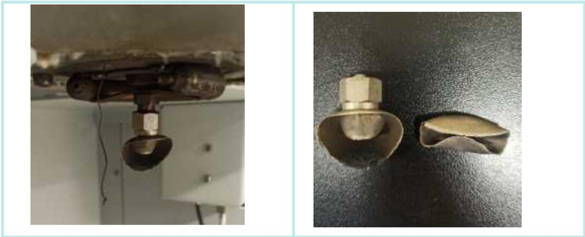
[그림 50] A-#6의 ARC분석 결과 : 시료용기의 파열
