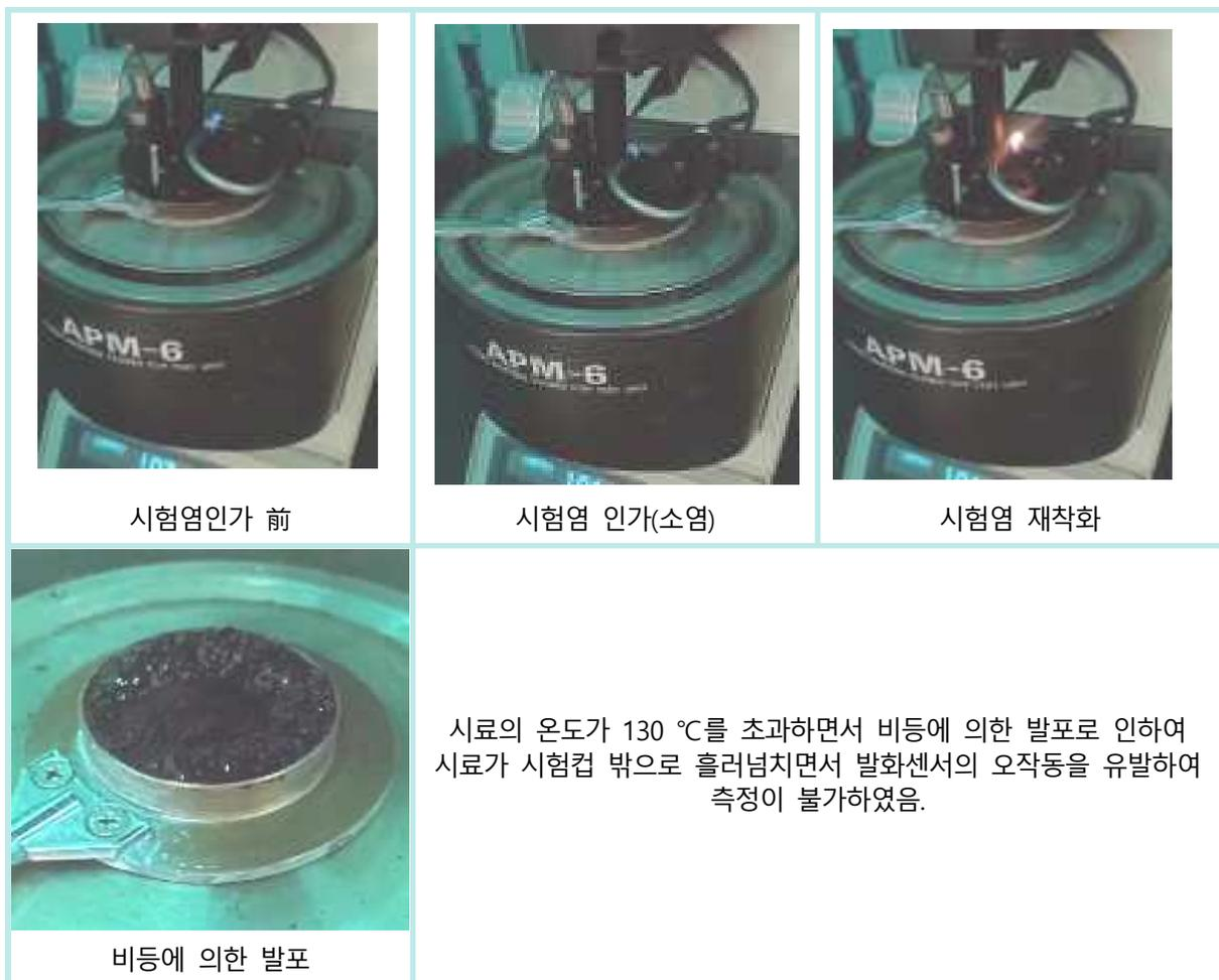
[그림 37] 펜스키마텐스식 밀폐컵 방식에 의한 A-#6의 인화점 분석 결과
