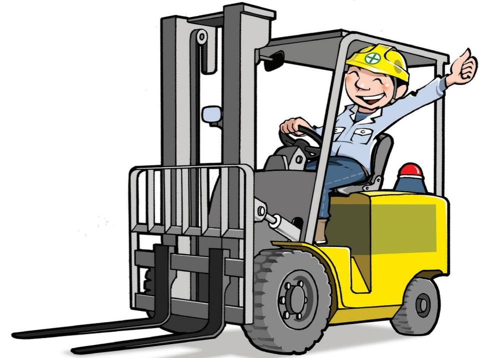
지게차는 하물 적재장치인 포크 fork · 램 ram, 승강장치인 마스트 mast 등이 차의 전면부에 장착된 하역용 자동차로서 포크리프트 fork lift 라고도 부른다. 지게차는 제조 · 건설 · 운수 · 도소매업 등에서중량물의 적재 · 하역 · 운반용으로 널리 사용되고 있다.
