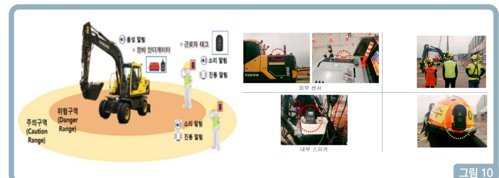
[그림 10] 장비 및 안전모 부착식 연동형 위험 알림장치
