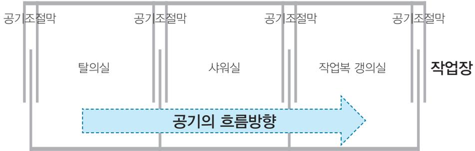
[그림 5-8] Z-LOCK의 설치 방법
