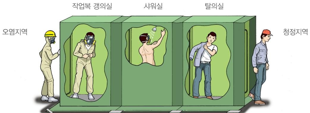
[그림 5-4] 위생설비 설치 및 사용
