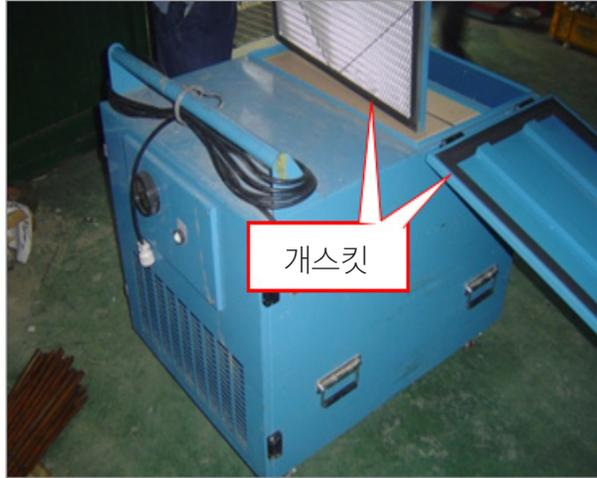
[그림 4-3] 공기누설 방지를 위한 개스킷 설치 예
