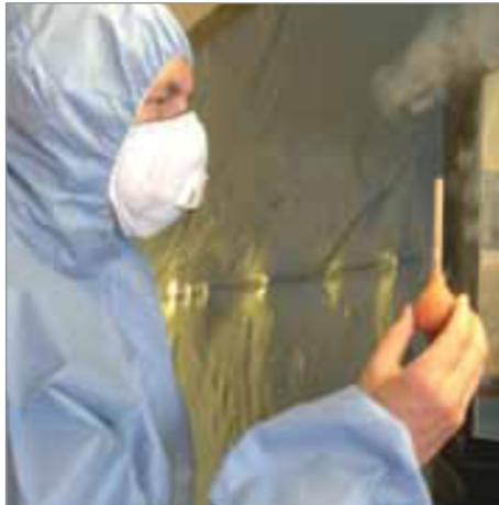
[그림 7-8] 발연관을 이용한 밀폐 적정유무 확인방법
